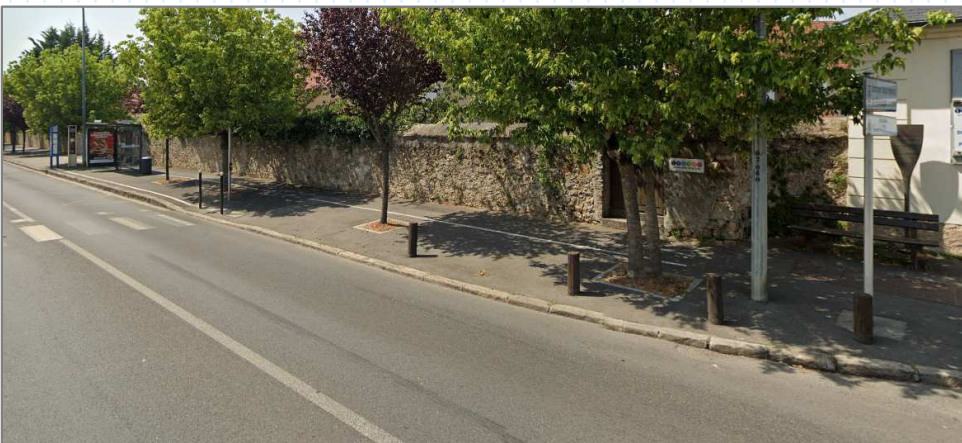
Trop d'obstacles (arbres, panneaux, abri bus) en rive Nord pour conserver une continuité vélo sur le trottoir
